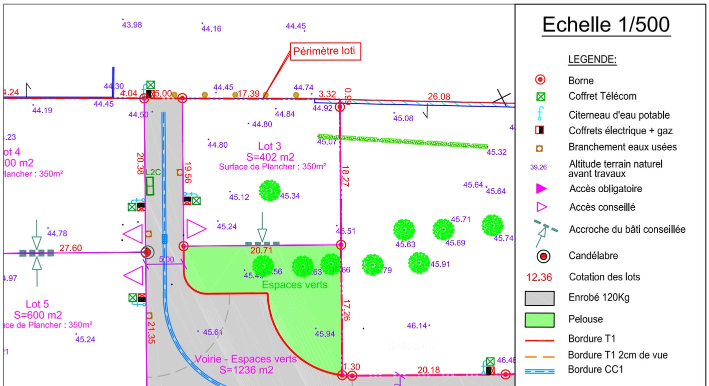
La position exacte des différents branchements sera vérifiée sur place avant la réalisation du projet de construction. La position des branchements est provisoire et pourra être modifiée pour des contraintes techniques. L'adaptation de la construction au terrain sera étudiée en tenant compte du niveau et de la position de la voie nouvelle ainsi que des réseaux créés.
